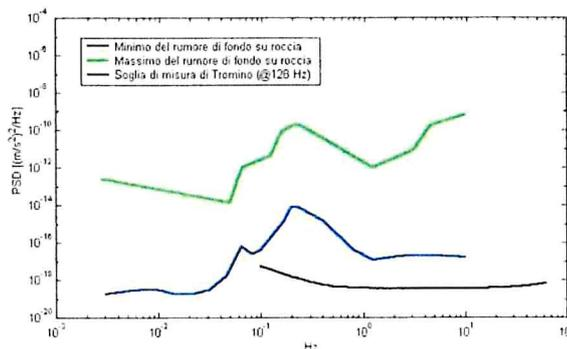
I dati sono stati convertiti in file ASCII mediante il software "Grilla", fornito a supporto dello strumento utilizzato, quindi elaborati per ottenere spettri di velocità in funzione della frequenza. Per evitare di introdurre basse frequenze spurie i dati sono stati corretti per offset e trend ma non filtrati così come raccomandato dalla norma DIN 4150-3.
