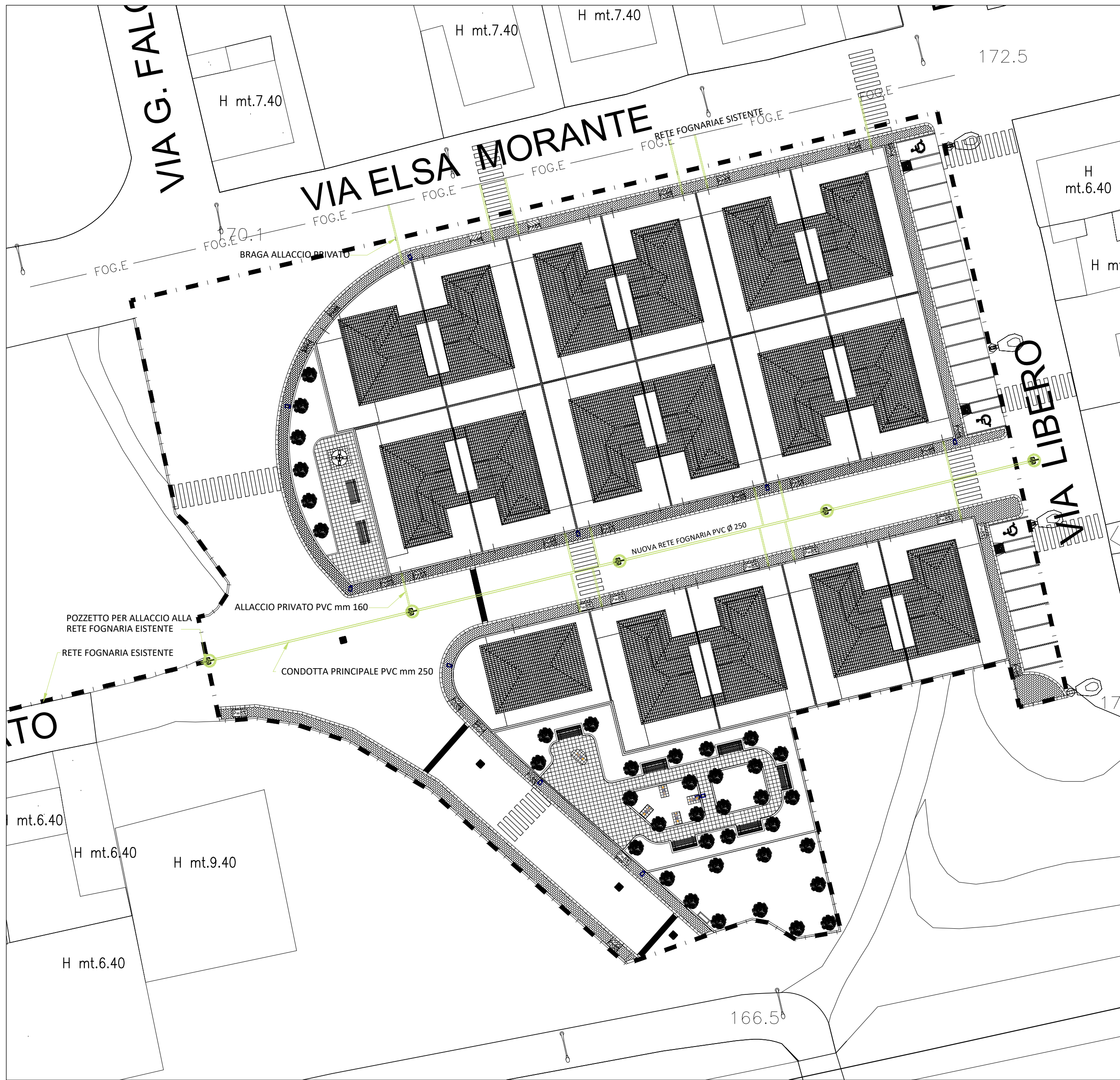
PLANIMETRIA DELLE SEDI VIARIE PREVISTE NEL PDL COM EVIDENZIATA LA RETE FOGNARIA DA REALIZZARE SCALA 1:400
