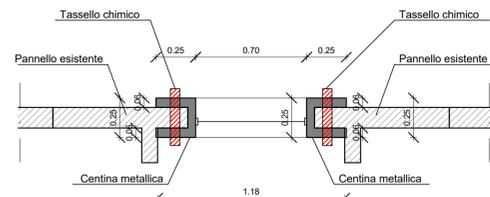
Sezione - intervento taglio pannelli per inserimento finestre di progetto - Scala 1:20
