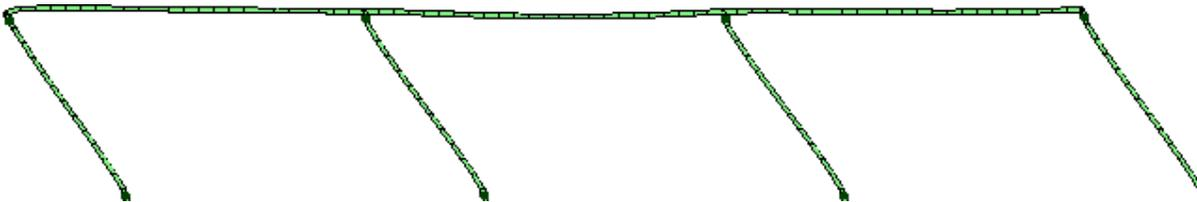
Analisi "Pushover +Y Triang + e". Configurazione della parete 8 in corrispondenza della capacita' relativa allo stato limite SLV (passo 69).
