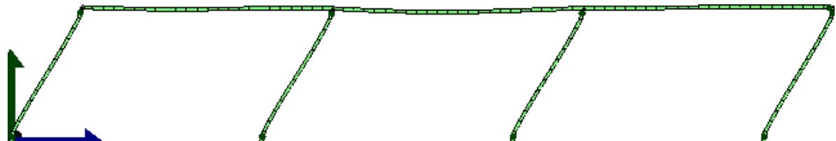
Analisi "Pushover +Y Triang + e". Configurazione della parete 9 in corrispondenza della capacita' relativa allo stato limite SLV (passo 69).
